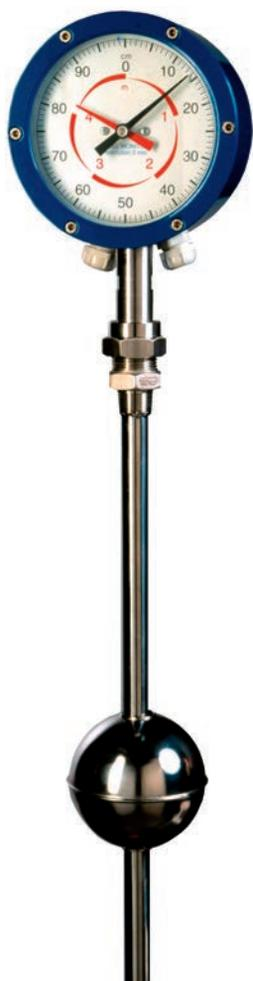
E' un sistema versatile, progettato per la misura del livello in piccoli e medi serbatoi da 10 a 300 m<sup>3</sup>. Il suo funzionamento è basato su un movimento di ingranaggi ad alta precisione, assicura un'indicazione visiva locale senza alimentazione elettrica. Semplice, compatto, robusto, affidabile ed esente da disturbi anche nelle condizioni operative più gravose.
